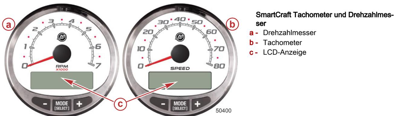
SmartCraft Tachometer und Drehzahlmesser
