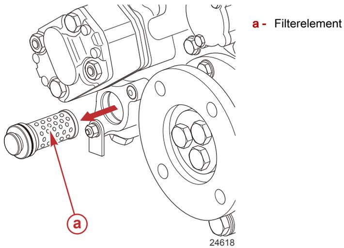
9. Das Filterelement mit einem milden Lösungsmittel reinigen (im Fachhandel erhältlich).
